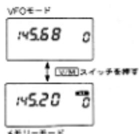
[V/M]スイッチは、VFO/メモリーモードの切換えを行うスイッチで、1回押すごとに切換わります。
